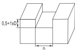
**Frezy wykonywane w tolerancji e8 są przeznaczone do frezowania rowków na wpusty w tolerancji P9**
